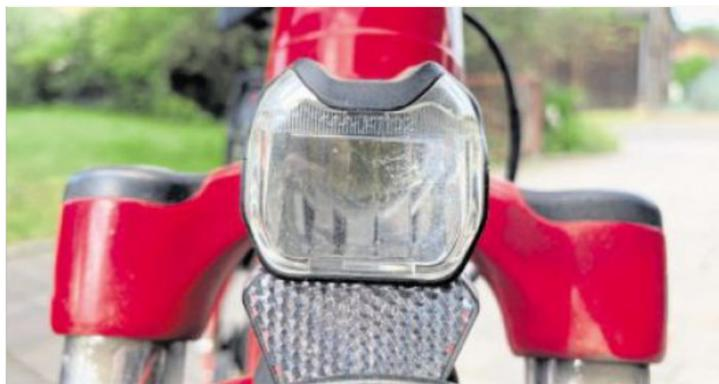
Wesentliche Elemente eines verkehrssicheren Fahrrades sind das Vorderlicht sowie der weiße Frontstrahler.
