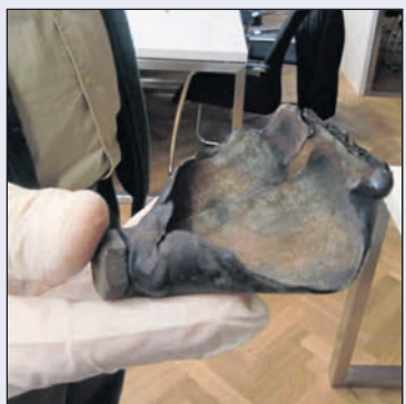
Das Metallrohr, das die Sprengstoffladung enthält, verbiegt sich bei der Explosion. Bild: hou
